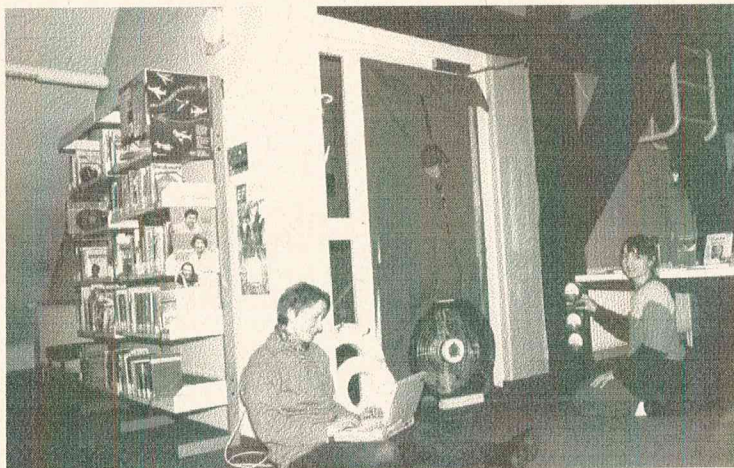
Luftdichtemessung in der Stadtbücherei
